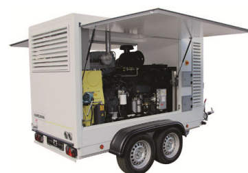
Équipement avec capotage insonorisé, version routière ou stationnaire
